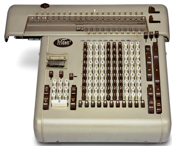
Friden SRQ-10, elektromechanische rekenmachine (collectie UvA computermuseum)
